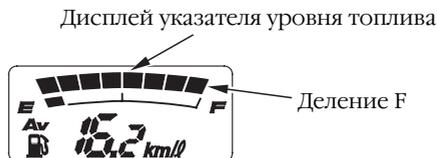
Если на указателе мигает деление E, это означает, что уровень топлива низок, и необходимо как можно скорее заправить бак топливом. При этом количество топлива в баке вертикально стоящего мотоцикла составляет приблизительно:
